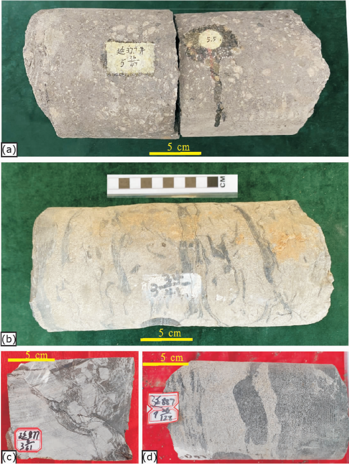
(a) 延 377 井中所夹的沉火山角砾凝灰岩;(b) 延 1227 井 3 回次本溪组含风暴撕裂状泥砾细砂岩;(c) 灰色钙质泥岩破碎和短距离错动沉积;(d) 风暴有关的冲刷成因砂、泥质砾屑(右)。
