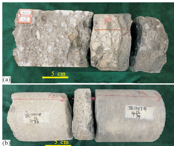
(a) Y864 井,细砾岩底界冲刷,内部具正粒序层理; (b) Y1003 井,砂岩底部与泥岩突变接触。
