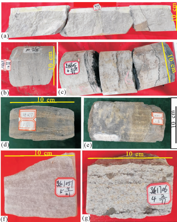
(a) 延 600 井,羽状交错层理细砂岩;(b) 延 887 井,羽状交错层理;(c) 含双或单黏土层细砂岩;(d) 波状交错层理;(e) 透镜状层理;(f) 低角度楔状交错层理;(g) 面状层理细砂岩。
